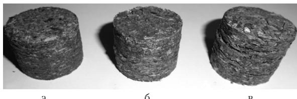
Рис.5. Зразки пелет діаметром 27 мм, виготовлених з соломи та ПЕТ, вміст якого складає, %: а – 10; б – 20; в – 30.
