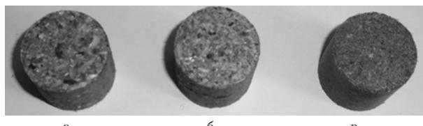
Рис.3. Зразки пелет (діаметр 27 мм, довжина 30 мм) з соломи (а), суміші тирса та соломи (б), соломи, тирси та листя дубу (в), виготовлених при тиску 263,2 МПа.
